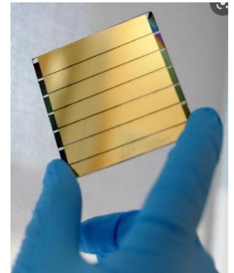
Des recherches en cours sur des panneaux en pérovskite en remplacement du silicium
